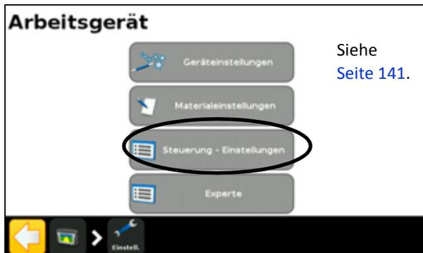
2. Berühren Sie im Bildschirm *Steuerung - Einstellungen* die Positionsschaltfläche der Position, die Sie einrichten möchten. Wenn Sie zum ersten Mal eine Steuerungseinstellung vornehmen, wird nur eine einzige Schaltfläche angezeigt, nämlich **Unbelegt**.
