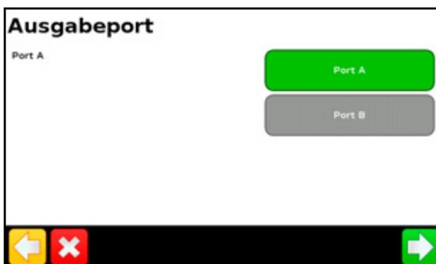
**Hinweis** – Konfigurieren Sie das Display so, dass keine NMEA-Meldungen auf dem Ausgabeport ausgegeben werden, an dem der Controller angeschlossen ist.
