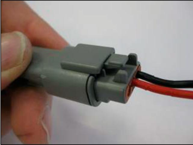
6. Stecken Sie das andere Ende des Adapterkabels zum Ferneinkuppeln in den Portreplikator (Pin 10 und Pin 11) am Kabel des EZ-Piloten, das mit dem Anschluss B des Displays CFX-750 verbunden ist:
