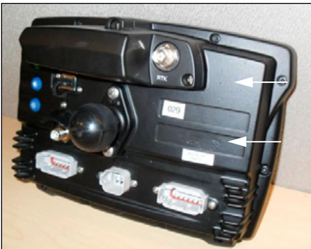
2. Befestigen Sie den RAM-Halter an der Kugel an der rautenförmigen Befestigungsplatte:
