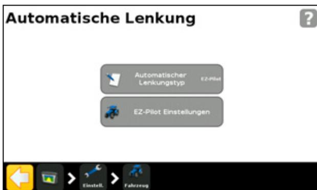
**Hinweis** – Wenn die Schaltfläche für die EZ-Pilot-Einstellungen nicht angezeigt wird, berühren Sie „Lenksystem Typ“ und wählen Sie „EZ-Pilot“ als Controller aus.
