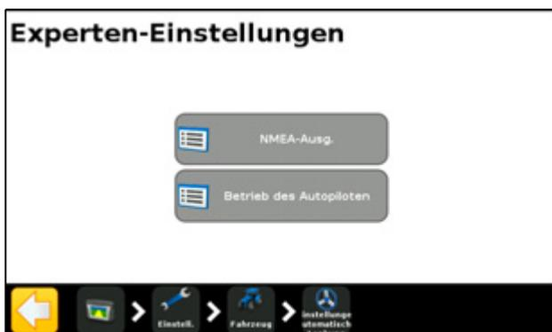
Über das Menü *Experten Einstellung* können Sie jetzt Betriebsparameter ändern und einrichten, um die Konfiguration des Autopiloten weiter zu optimieren und NMEA-Übertragungsprotokolle zu definieren.
