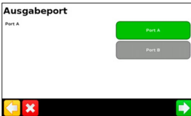
2. Stellen Sie als Ausgabeport den Anschluss des Displays ein, an den der Controller angeschlossen ist, also COM oder AUX.
