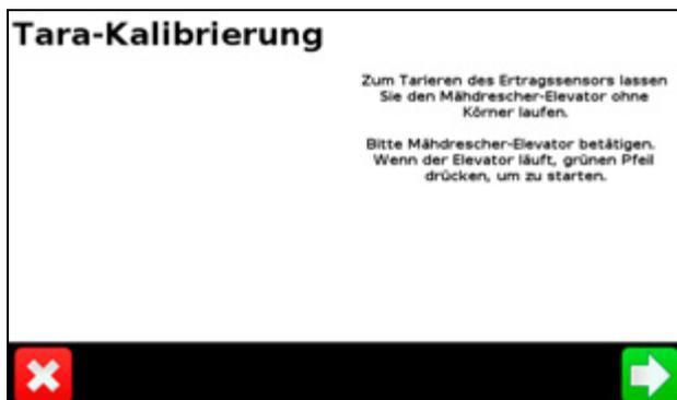
**Hinweis** – Die Kalibrierung der Tara ist für die Leistung des Systems wichtig. Stellen Sie sicher, dass der Reinkornelevator die richtige Spannung aufweist und alle Schaufelblätter vorhanden und gleich groß sind.
