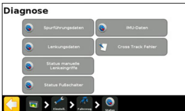
Im Bildschirm *Diagnose* können Sie die Hauptsensoreingaben für den ausgewählten Fahrzeugtyp anzeigen. Auf jeder Seite werden die Rohwerte und die skalierten Werte der Sensordaten angezeigt. Die Daten im Bildschirm *Diagnose* werden ständig aktualisiert, um die Verbindung in Echtzeit auswerten zu können.
